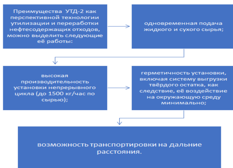
Рис. 3. Преимущества установки термической деструкции (УТД-2)
