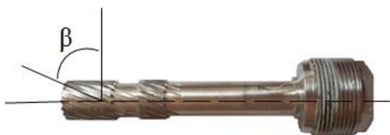
Рис.8. Буртик форсунки со шнеком [9]
