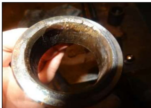
Рис. 4. Фотоматериал с 4 этапа исследований отказов замковой опоры (узел – стопорное кольцо)
